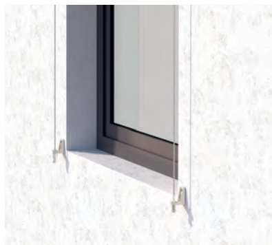
Vedení ocelovým lankem
